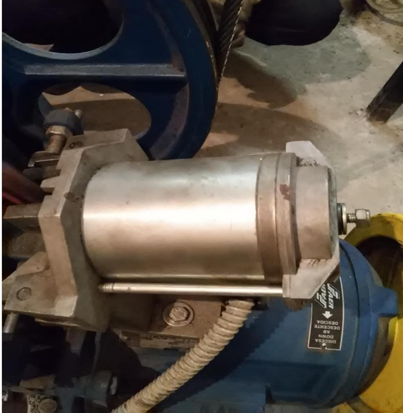
2) Le due ganasce del freno dell'argano sono dotate di un'unica bobina di comando in presenza dell'inverter.
